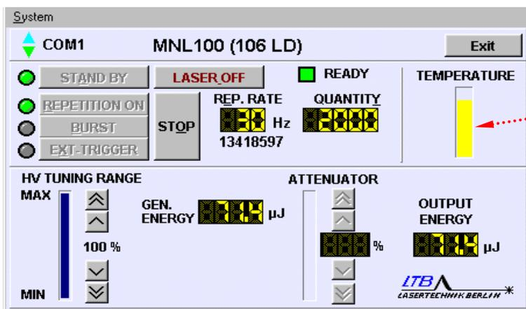
Steigt die Temperatur weiter an, wechselt die Anzeige auf rot und der Laser schaltet ab.
