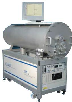
Innenleben. Zwei Jahre harte Entwicklungsarbeit stecken darin. ELIAS ist ein hochauflösendes Echelle-Spektrometer. Es dient der spektralen Charakterisierung von schmalbandigen Lichtquellen für die Laserlithographie, den Excimerlasern. Das Gerät ist – noch – konkurrenzlos und nicht nur jenseits des großen Teiches heiß begehrt. „Wir beliefern
