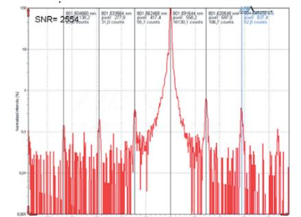
Modenspektrum eines Diodenlasers 800 nm
